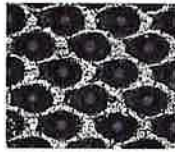
Keramikbeschichtete Rasterwalze lasergraviert, 120 L/cm 45°-Winkelung
