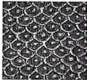
Keramikbeschichtete Rasterwalze lasergraviert, 195 L/cm 45°-Winkelung
