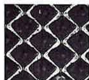
Chromwalze graviert mit Helio-Klischograph, 120 L/cm
