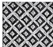
Chromwalze Stumpfpyramide molettiert, 140 L/cm
